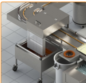
Extracteur magnétique Bac mobile de réception des couverts
